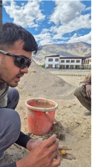
Les tests de sol ont été réalisés sous la supervision de l'architecte HAIL, M. Shubham Ray, en coordination avec l'entrepreneur, M. Deb Bahadur Sunar. L'objectif principal était de déterminer les proportions relatives d'argile, de limon et de sable dans le sol local afin d'évaluer son aptitude à produire des briques de terre de haute qualité ainsi que des briques compactées en paille–argile.
